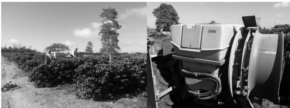
Figura 1. Pulverizador hidropneumático montado utilizado para realizar a aplicação de fungicida na lavoura de café Conilon.
